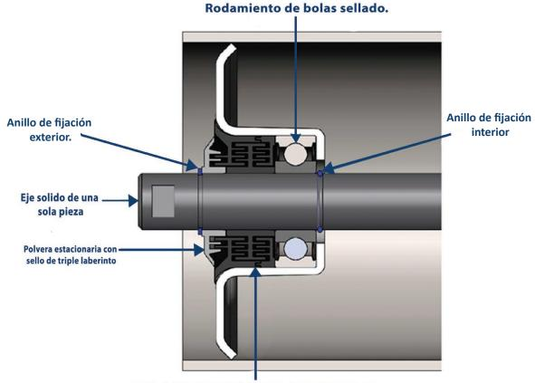
Sello doble de triple laberinto lleno de grasa de lithio, fijado al eje, cubriendo el rodamiento
